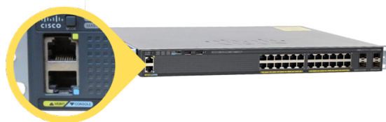
Console Port แบบ RJ45
